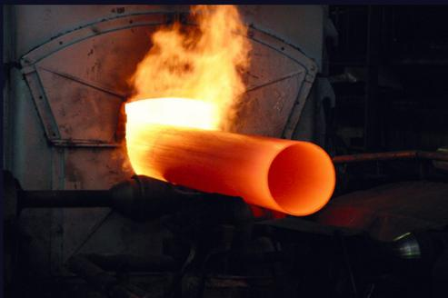
Объемная термическая обработка труб большого диаметра используется для улучшения свойств металла, снятия остаточных напряжений, повышения прочности сварных конструкций, сохранения размеров и формы изделия при механической обработке и эксплуатации.
